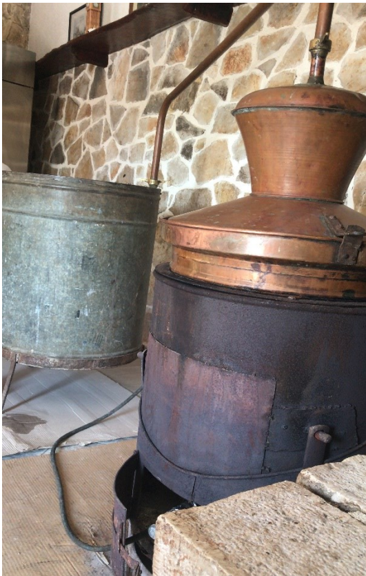
Slika 3.4. Priručni kotao za destilaciju u domaćinstvu (vanjski izgled)
