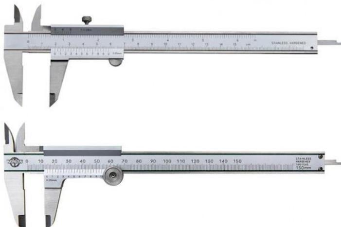
Slika 3.1.1.1. Pomična mjerka
