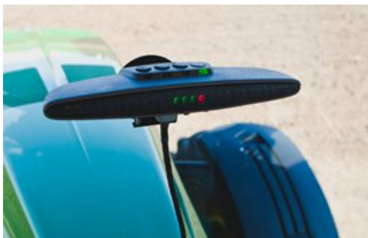
Slika 7.3. GreenStar lightbar Izvor: http://salesmanual.deere.com
