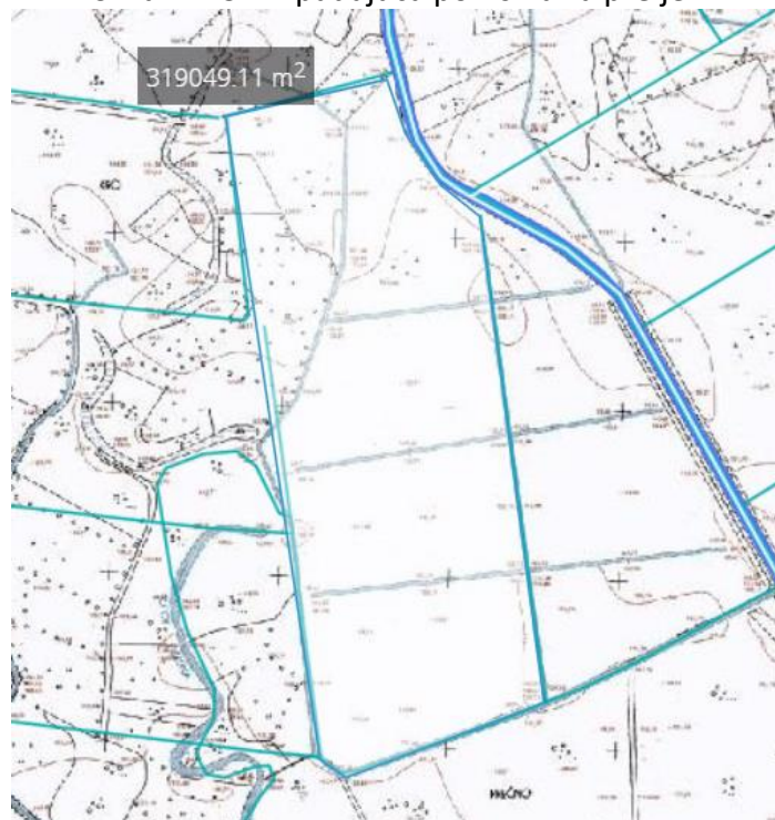
Slika 4.2.3. Pripadajuća površina za preljev
