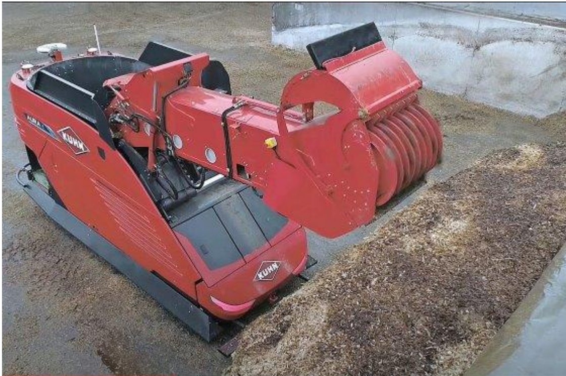
Slika 4.26. Robot za izuzimanje, miješanje i raspodjelu silaže Kuhn Aura (Izvor: https://www.dairyglobal.net )
