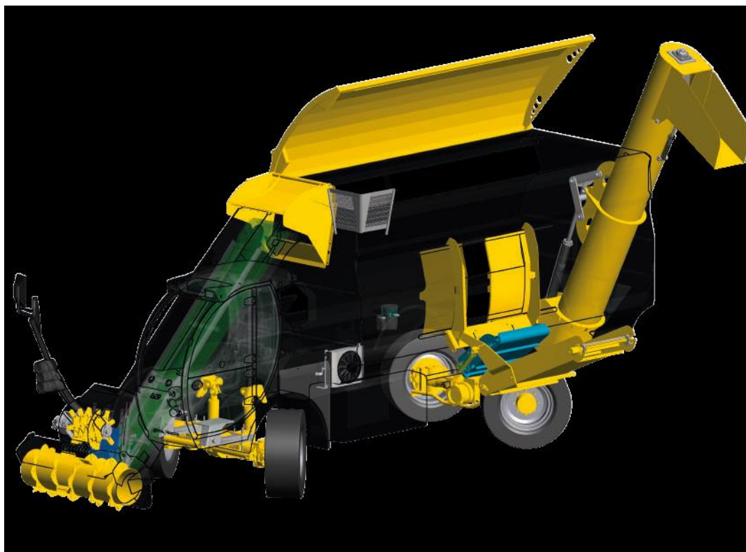
Slika 4.1. Shematski prikaz samokretnog stroja za izuzimanje, miješanje i raspodjelu silaže (Izvor: https://www.sgariboldi.it )
