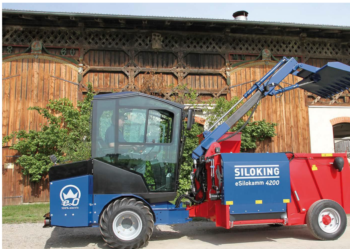
Slika 4.25. Električni samokretni stroj Siloking E-Silokamm 4200
