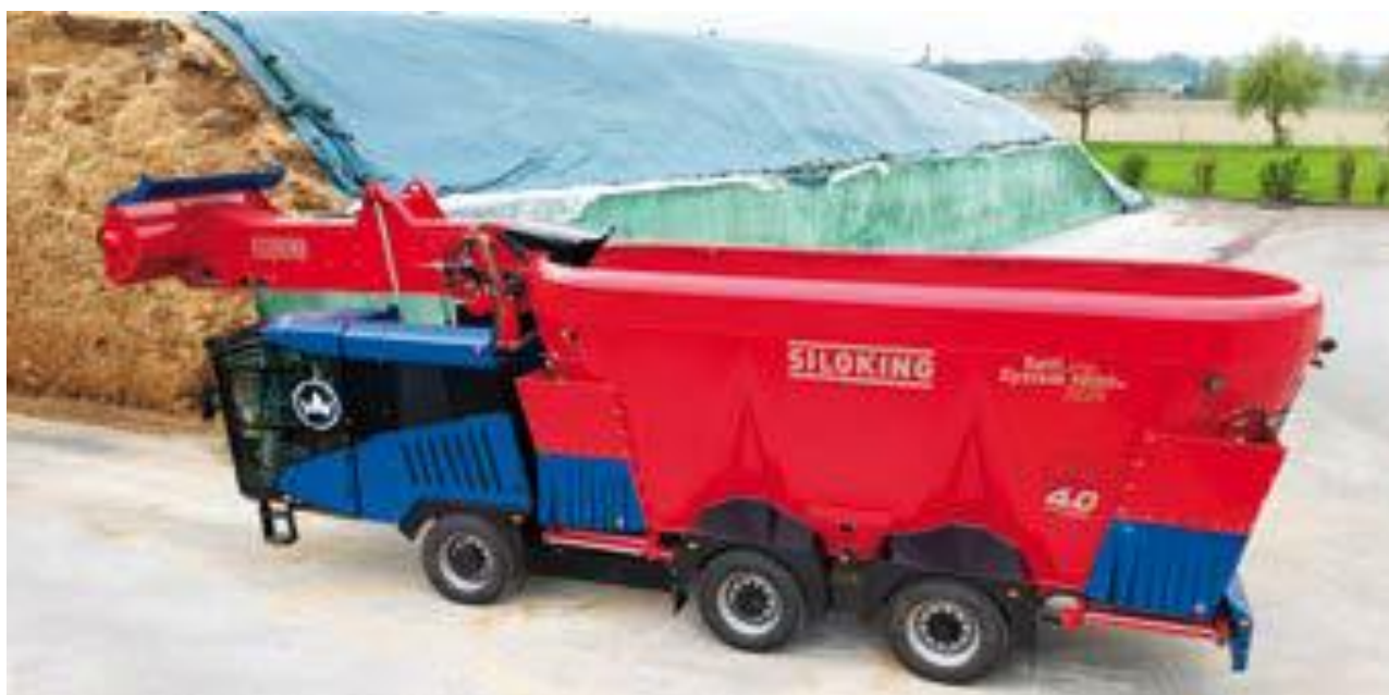
Slika 4.12. Samokretni stroj za izuzimanje, miješanje i raspodjelu silaže Siloking SelfLine System 1000+ 3225 (Izvor: https://www.siloking.com )
