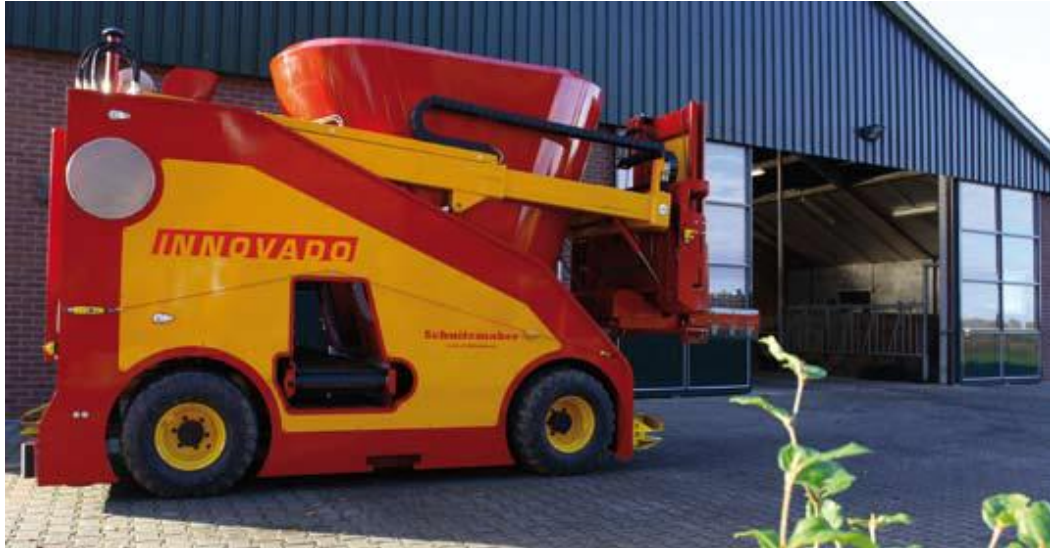
Slika 4.21. Robotizirani stroj Schuitmaker Innovado (Izvor: https://www.sr-schuitmaker.nl )
