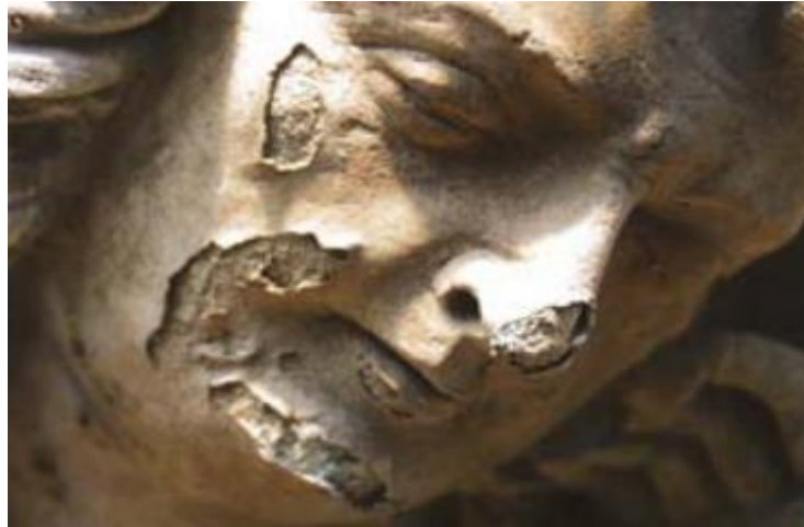
Slika 2.2.9. Odvajanje – eksfolijacija izvor: Vergès-Belmin, 2008.
