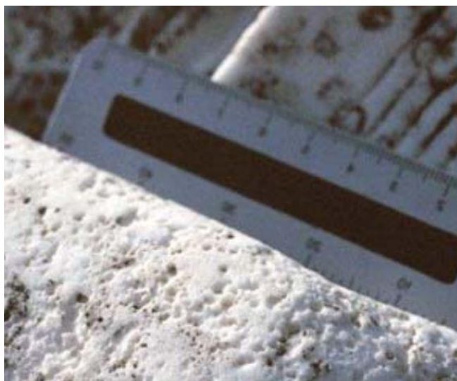
Slika 2.2.16. Oblik nastao gubitkom materijala - rupičanje izvor: Vergès-Belmin, 2008.
