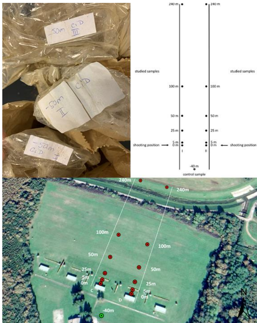
Slika 5. Uzorci tla prikupljeni sa streljane Luže i shematski prikaz plana uzorkovanja
