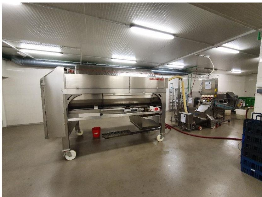
Slika 3.2. Pogon za preradu jabuka (preša) Proizvodnja Jurišić d.o.o.
