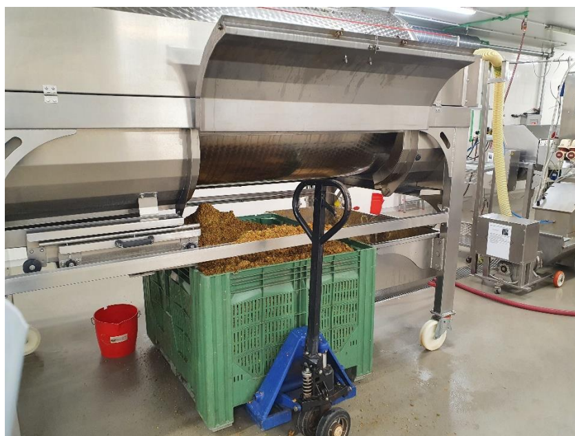
Slika 3.3. Odstranjivanje organskog ostatka iz preše nakon proizvodnje soka Proizvodnja Jurišić d.o.o.
