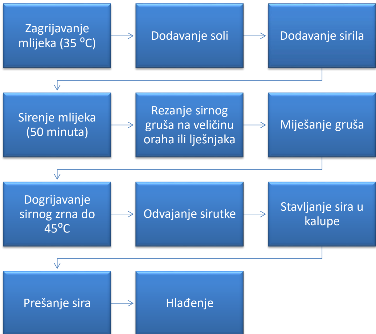
Slika 3.1.1. Dijagram tijeka proizvodnje sira škripavca
