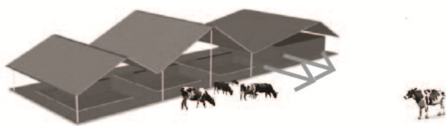
Grafički prikaz 7.1.2.1. Prikaz strukture staje otvorenog karaktera prema De Kwatrijn konceptu
