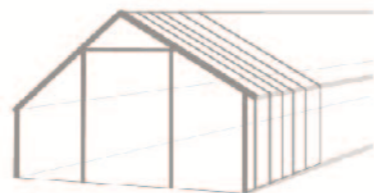
krov prekriven transparentnim platnom za zaštitu od vremenskih ekstrema i stvaranje zasjene
