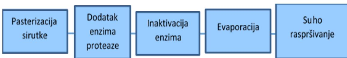
Slika 2. 1. Shematski prikaz procesa proizvodnje hidrolizata proteina sirutke
