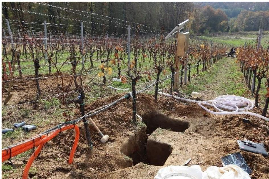
**Slika 3.2.1.** Iskop rupe za postavljanje tlačnih lizimetara
