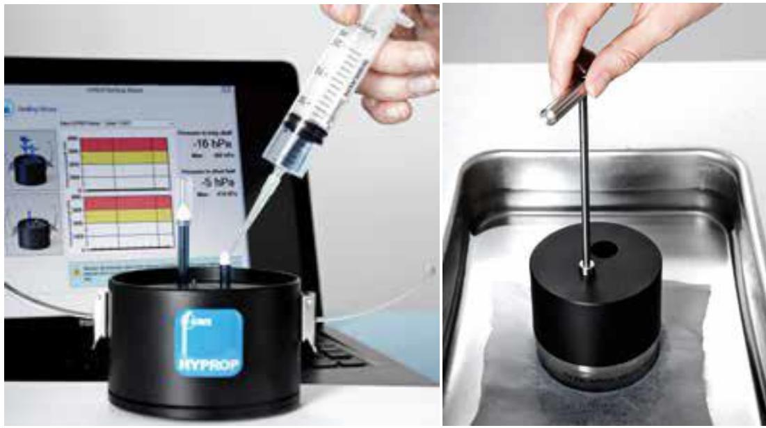
**Slika 3.2.2.1.3.** a) Tenziometri sa senzorskom jedinicom, b) Formiranje rupa u tlu
