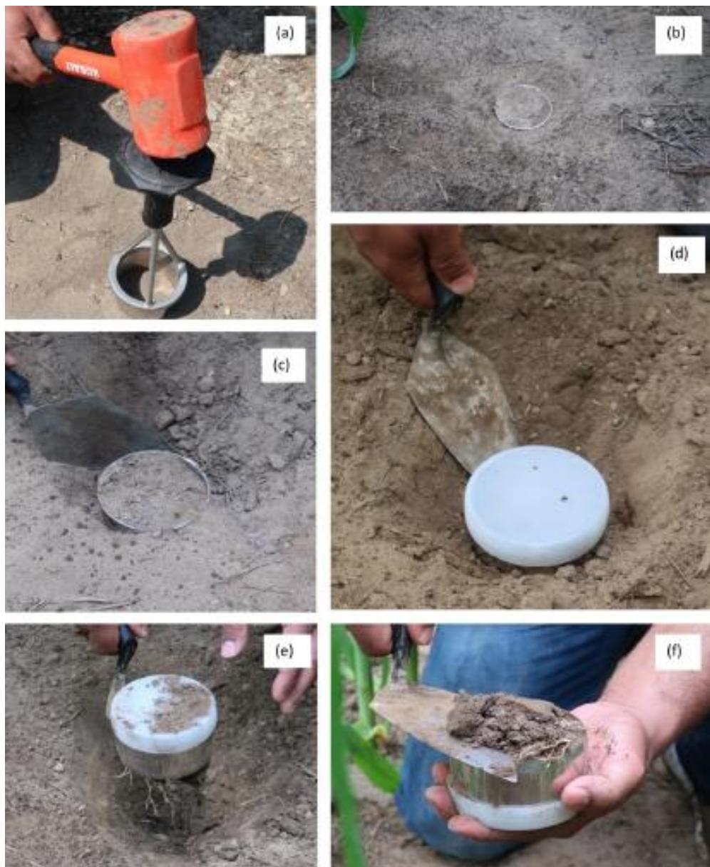
**Slika 3.2.2.3.** Uzorkovanje tla: (a) zabijanje cilindra, (b) ispunjeni cilindar, (c) uklanjanje tla s bočne strane cilindra, (d) stavljanje poklopca prije vađenja, (e) vađenje uzorka, (f) ravnjanje površine cilindra
