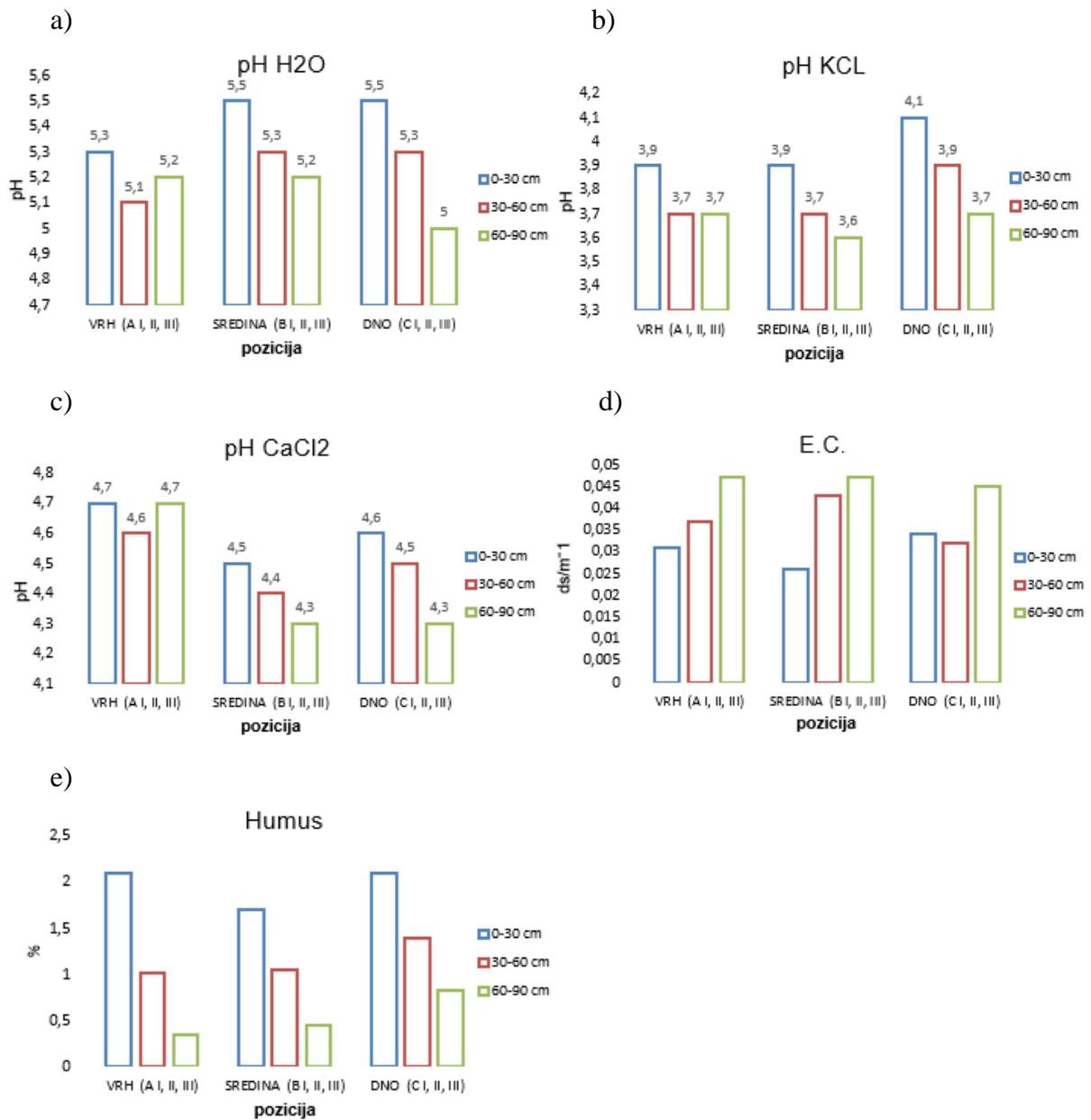
**Slika 4.1.1.** Grafički prikaz analize kemijskog sastava tla na pozicijama A – vrh padine, B – sredina padine, C – dno padine, za dubine 0–30, 30–60 i 60–90 cm za: a) pH<sub>H<sub>2</sub>O</sub>, b) pH<sub>KCl</sub>, c)pH<sub>CaCl<sub>2</sub></sub>, d) EC, e) humus.
