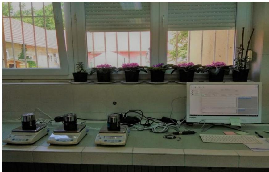
**Slika 3.2.2.1.4.** Neporušeni uzorci tla u cilindrima tijekom mjerjenja na HYPROP sustavu.
