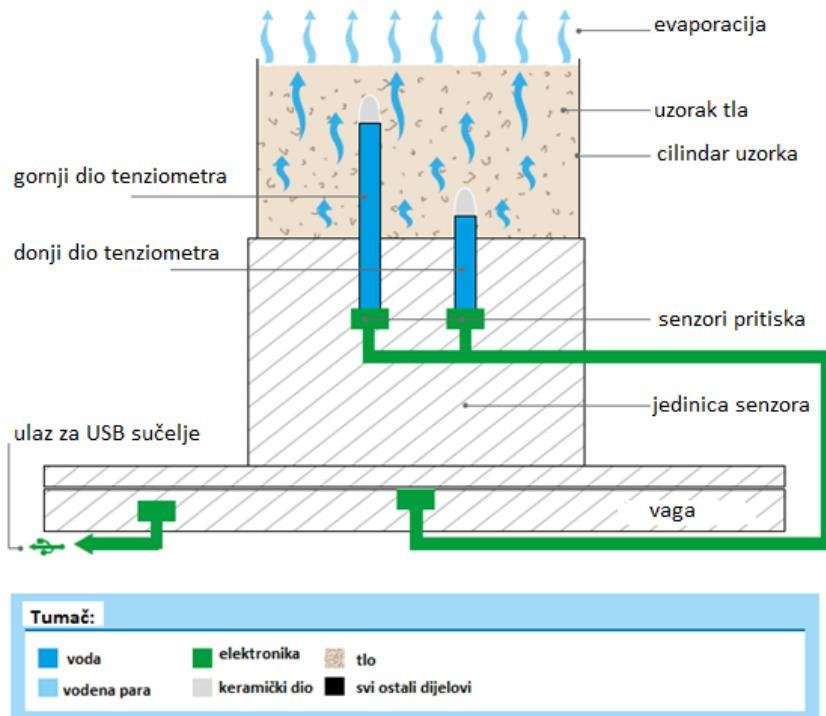
**Slika 3.2.2.1.1.** Shematski prikaz HYPROP sustava
