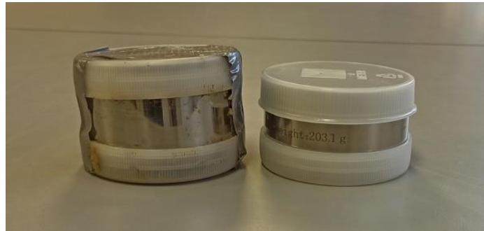
**Slika 3.2.2.2.** Cilindri volumena  $250 \text{ cm}^3$  za uzorkovanje neporušenih uzoraka tla (METER Group)
