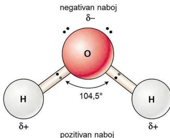
**Slika 2.1.1.** Molekula vode. Kovalentne veze između atoma kisika i dva atoma vodika zatvaraju kut od  $104,5^\circ$ . Negativni i pozitivni naboјi ( $\delta^-$  i  $\delta^+$ ) na suprotnim stranama molekule vode omogućuju stvaranje vodikovih veza između molekula vode.
