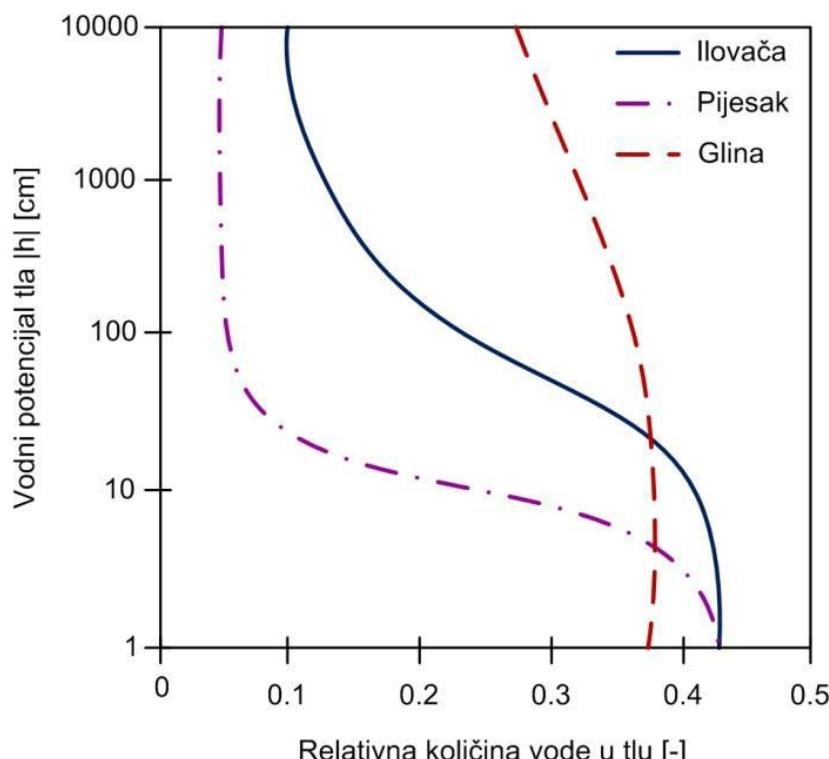
**Slika 2.4.1.** Primjer retencijske krivulje tla za pjesak, ilovaču i glinu(prikazano prema hidrauličkim parametrima preuzetima od Carsel i Parish, 1988).
