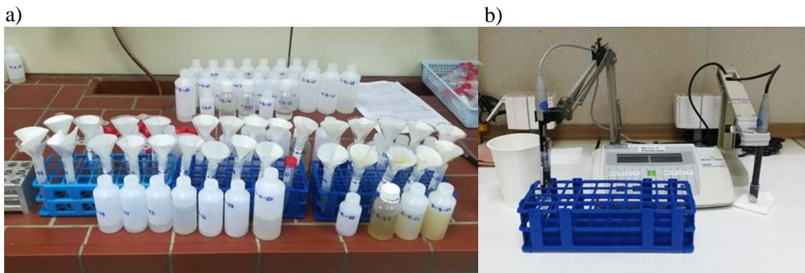
**Slika 3.2.1.1.** a) Priprema uzoraka za mjerjenje pH i električne vodljivosti, i b) mjerjenje pH tla i električne vodljivosti pH-metrom i konduktometrom (EC-metar) *MettlerToledo MPC227* u suspenziji u vodi.
