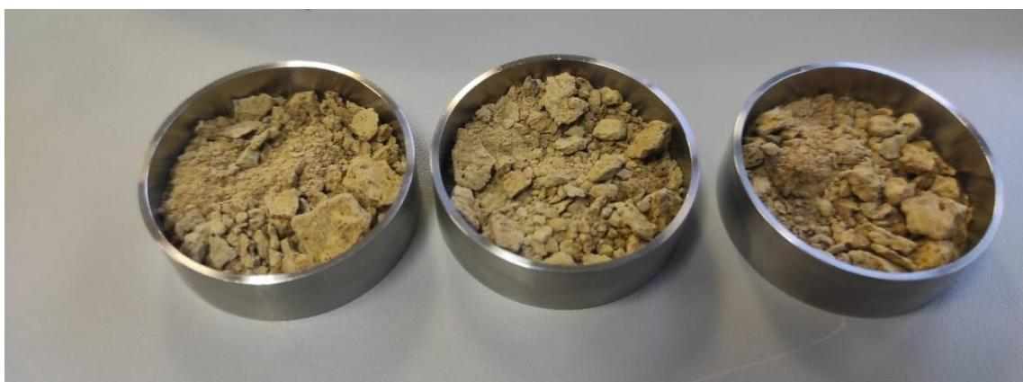
Slika 3.2.2.2.3. Uzorci tla u metalnim posudicama pripremljeni za mjerjenje.
