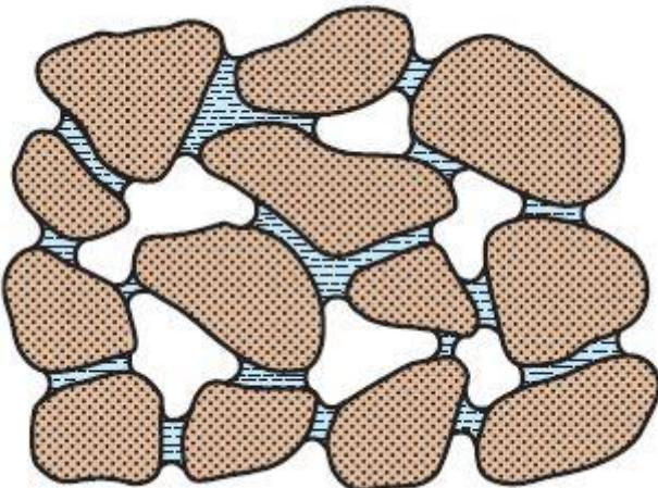
**Slika 2.1.2.1.** Prikaz nesaturirane zone tla i ispunjenosti pora vodom i zrakom
