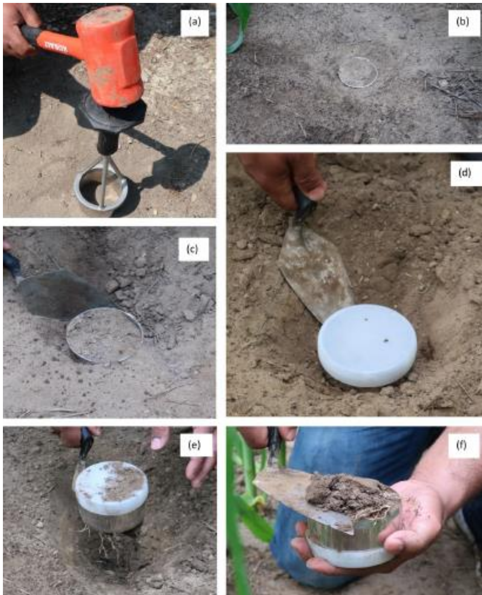
Slika 3.2.2.3. Uzorkovanje tla: (a) zabijanje cilindra, (b) ispunjeni cilindar, (c) uklanjanje tla s bočne strane cilindra, (d) stavljanje poklopca prije vađenja, (e) vađenje uzorka, (f) ravnanje površine cilindra Izvor: Shokrana i Ghane, 2020.
