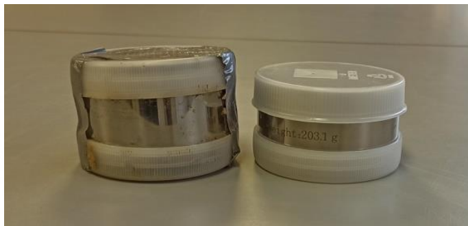
Slika 3.2.2.2. Cilindri volumena 250 \text{ cm}^3 za uzorkovanje neporušenih uzoraka tla (METER Group)
