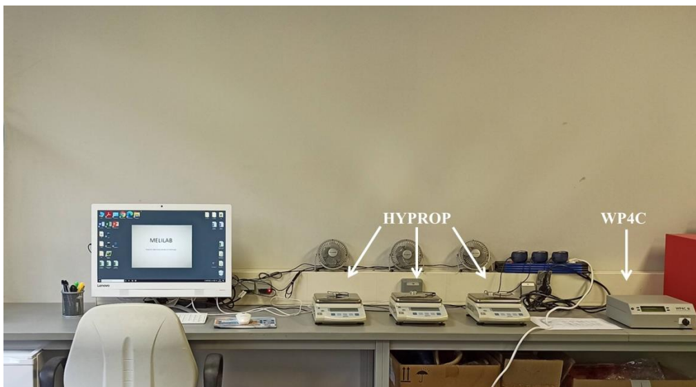
Slika 3.2.2.4. Oprema za procjenu retencijskih krivulja tla i određivanje hidrauličkih parametara (HYPROP, WP4C) smještena u laboratoriju Zavoda za melioracije.
