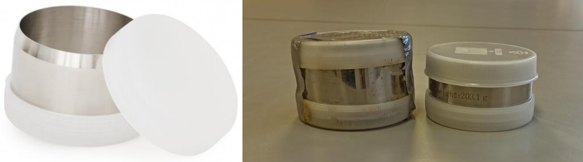
Slika 3.2.2.2. Cilindri volumena 250 \text{ cm}^3 za uzorkovanje neporušenih uzoraka tla (METER Group)
