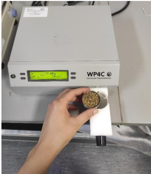
Slika 3.2.2.2.1. Umetanje metalne posudice u WP4C uređaj.
