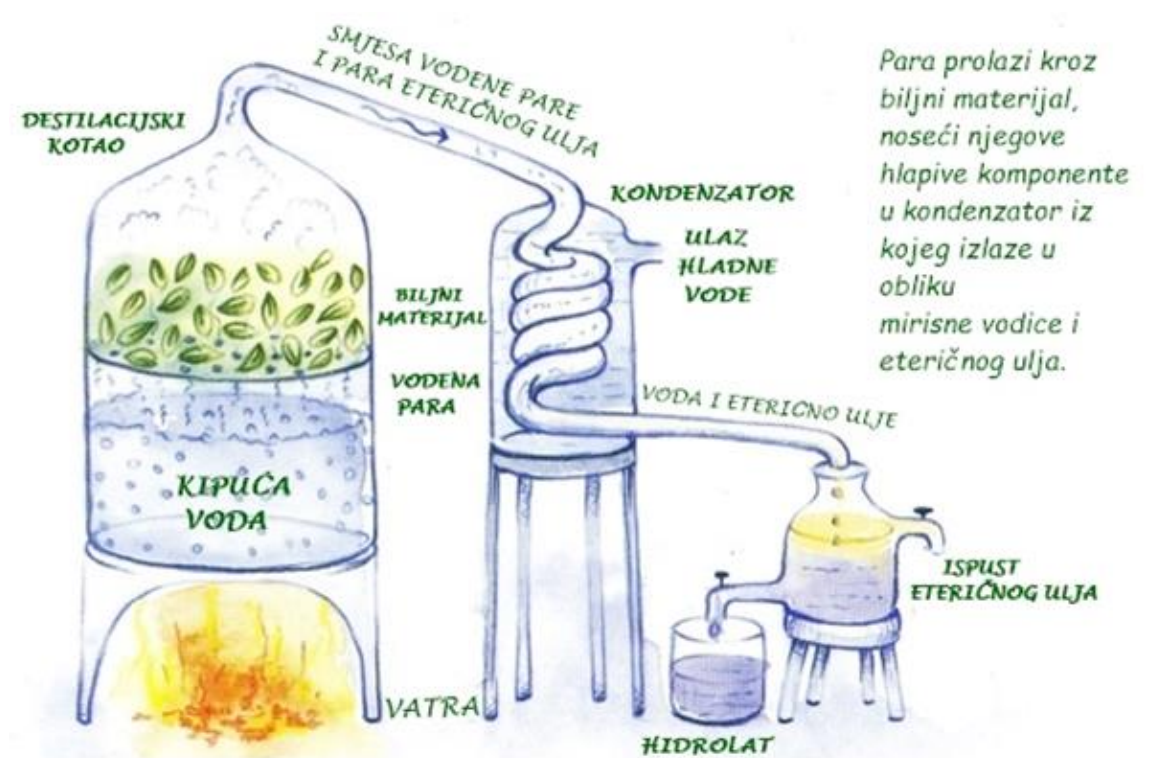
Slika 17. Prikaz destilacije vodenom parom (izvor originala: templesweep.com, 2015., autorska dorada)
