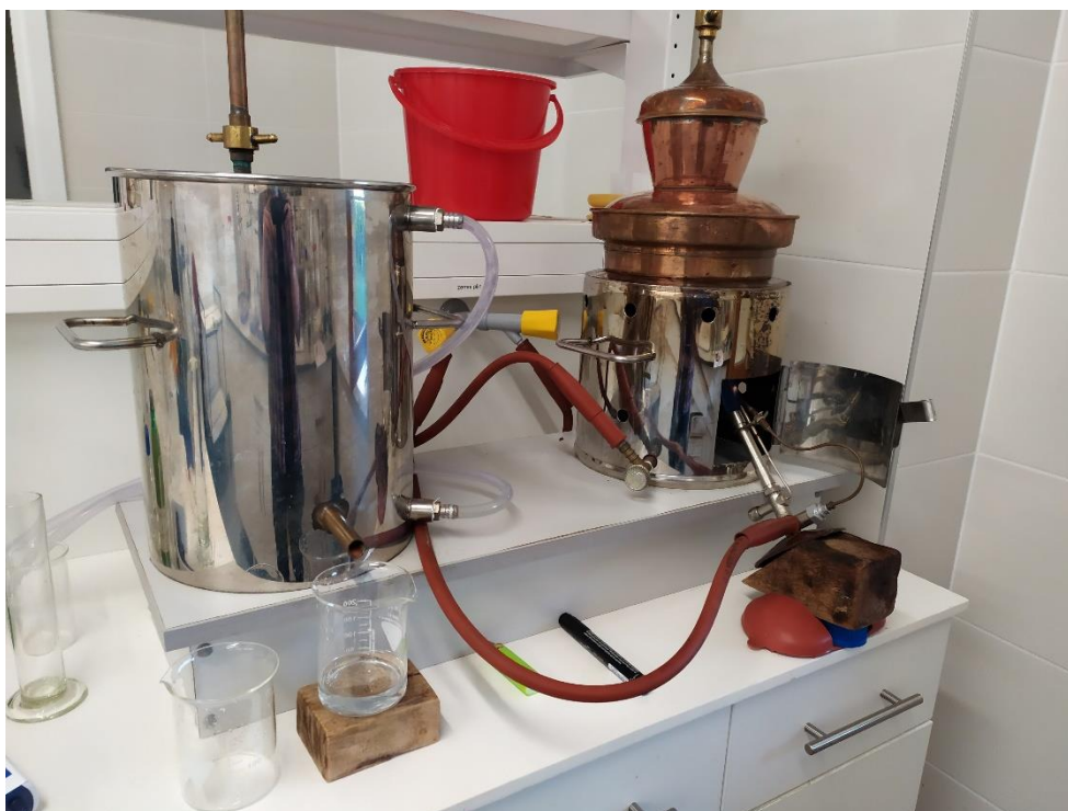
Slika 5.3.1. Jednostavni destilacijski uređaj kapaciteta 5L
