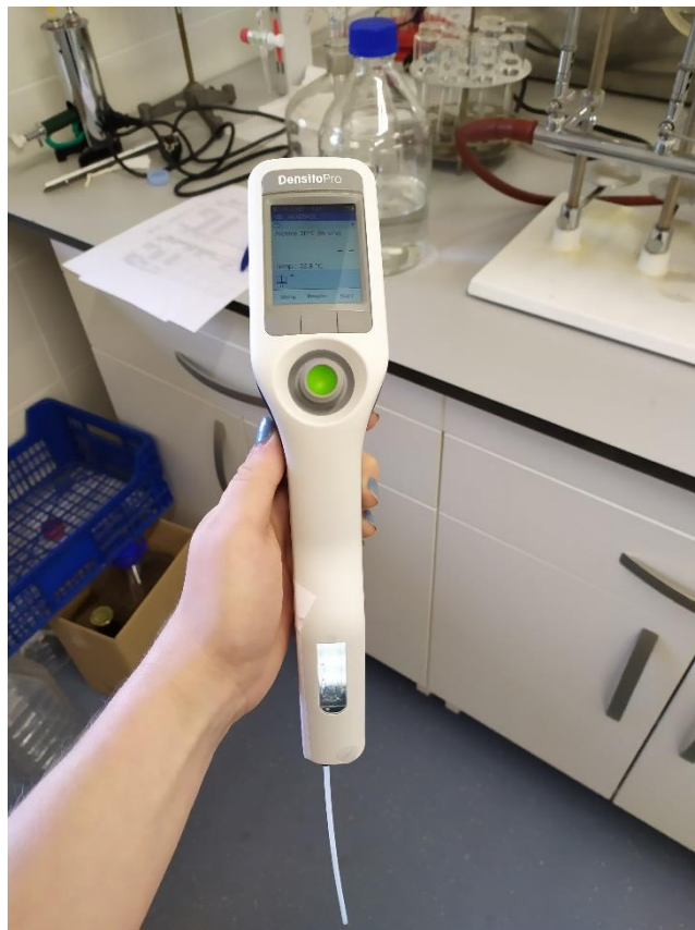
Slika 5.12. Uređaj za mjerenje alkoholne jakosti DensitoPro
