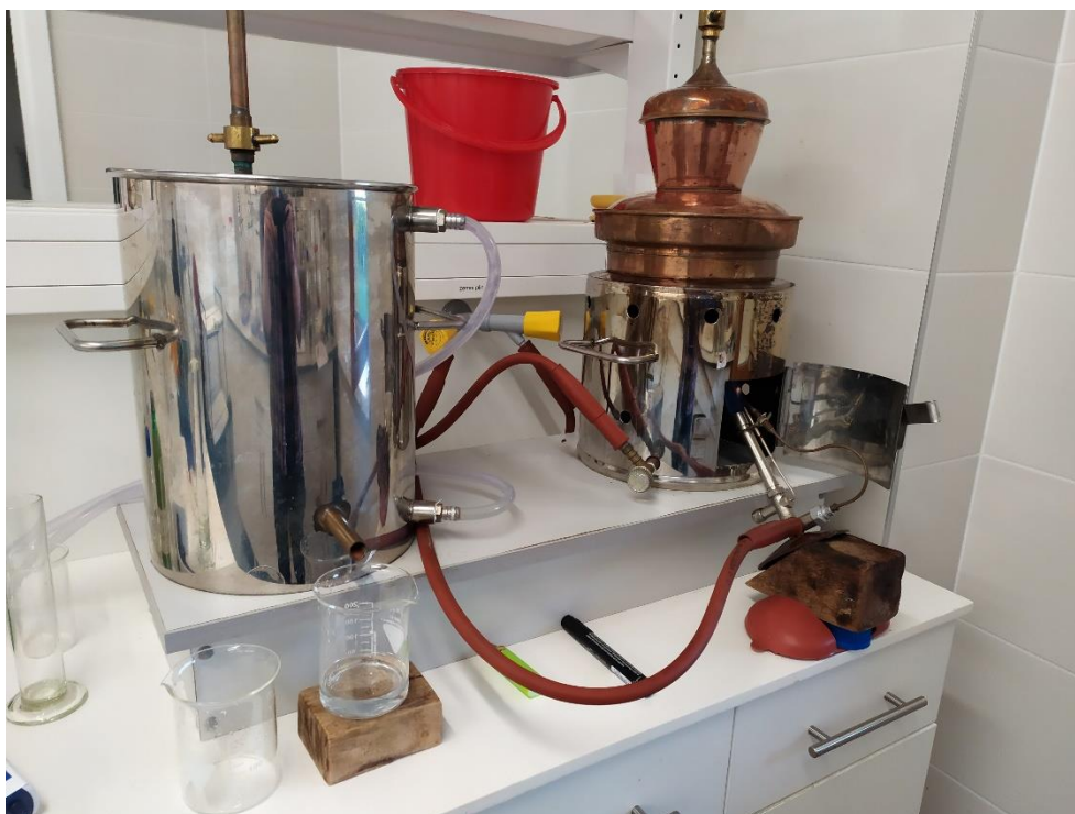
Slika 5.3.1. Jednostavni destilacijski uređaj kapaciteta 5L
