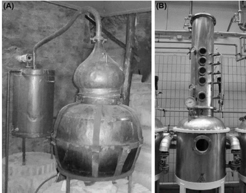
Slika 3.1. Uređaji za destilaciju koji se koristi za proizvodnju voćnih alkoholnih pića: (A) Charentais alembic (francuski stil); (B) Uređaj s kolonama (njemački stil)
