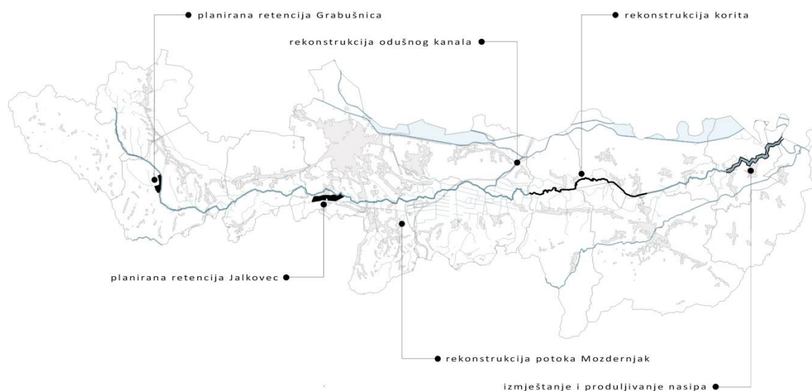
Grafički prikaz 4.13: Planirani zahvati prema EU projektu zaštite od poplava na slivu rijeke Plitvice
