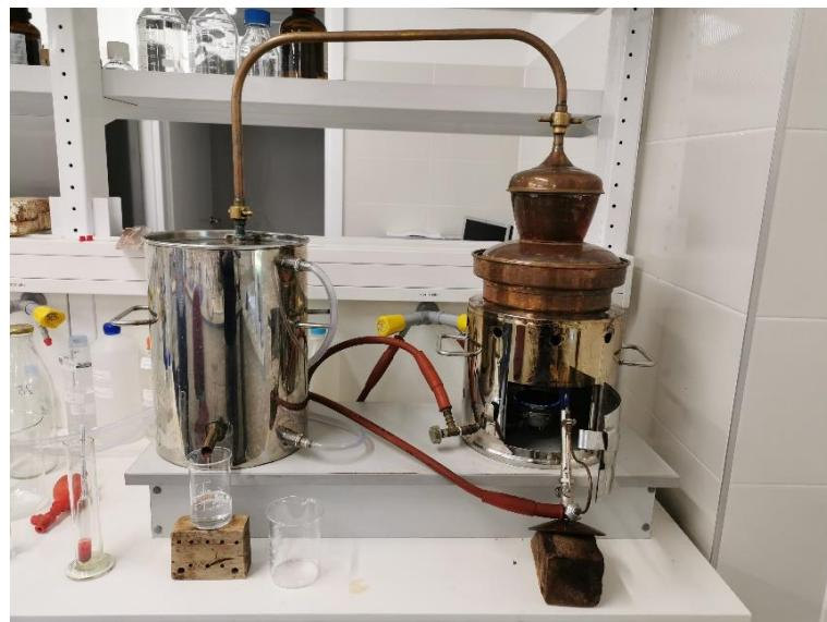
Slika 3.5. Korišteni 'Alambic' destilacijski uređaj
