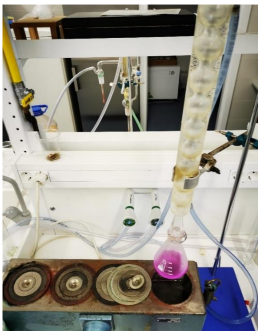
Slika 2.7. Analiza uzorka u parnoj kupelji sa povratnim hladilom Izvor: Autor
