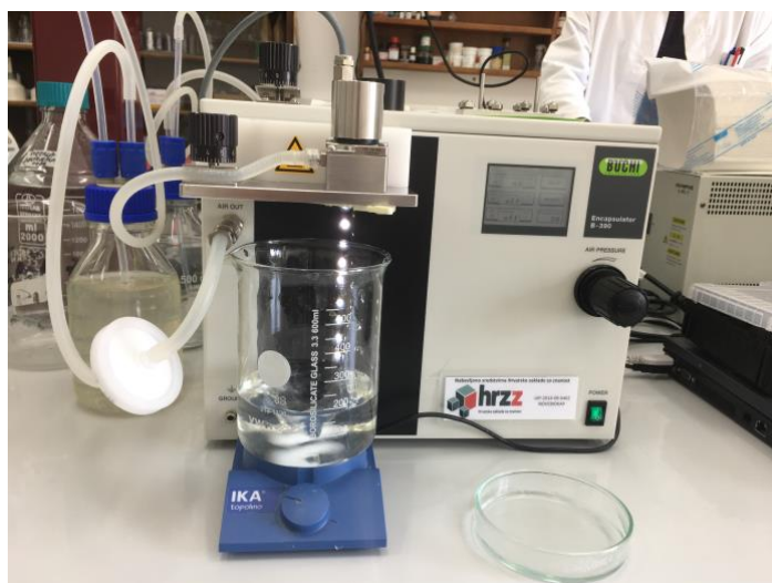
Slika 2.2.1. Izrada mikrokapsula u Encapsulatoru B – 390
