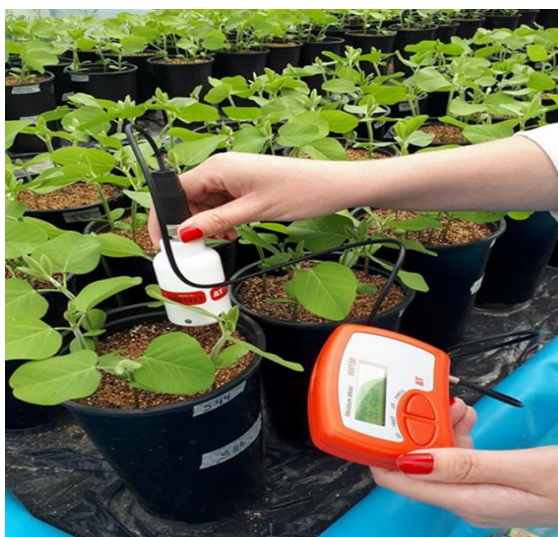
Slika 33. Mjerenje sadržaja vode u supstratu.
