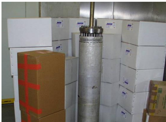
Slika 31. Panoramski uređaj s ^{60}\text{Co} izvorom gama zračenja.
