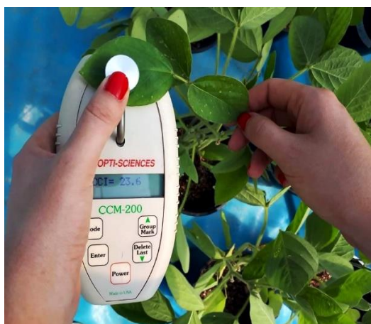
Slika 34. Mjerenje indeksa sadržaja klorofila u biljci pomoću klorofilmetra.
