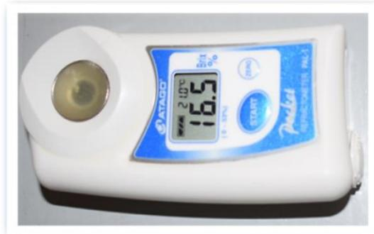
Slika 7. Digitalni refraktometar (ATAGO PAL-1, Japan)
