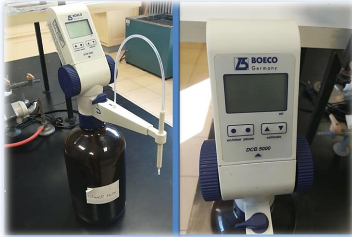
Slika 9. Digitalna kontinuirana bireta (Boeco DCB 5000, Njemačka)
