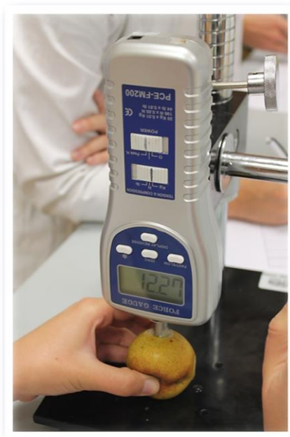
Slika 5. Digitalni stolni penetrometar (PCE-PT200, PCE Instruments, Southampton, UK) (Foto: M. Skendrović Babojelić)
