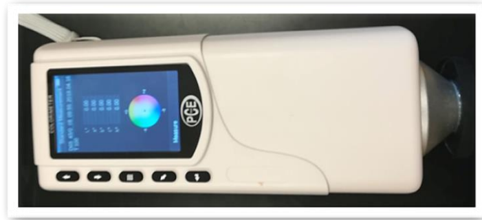
Slika 1. Kolorimetar (PCE-CSM2, PCE Instruments UK Ltd.)
