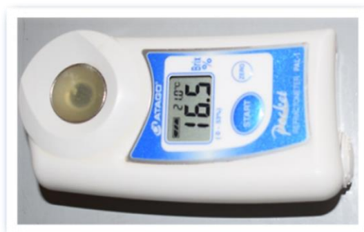
Slika 7. Digitalni refraktometar (ATAGO PAL-1, Japan)
