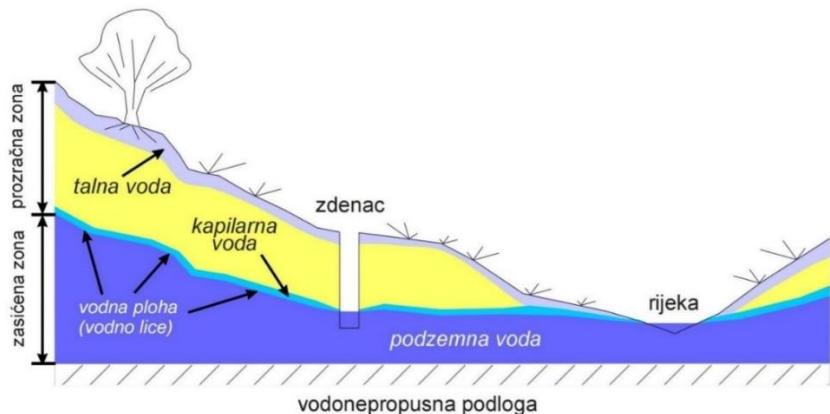
Slika 2.1.1.1. Shematski prikaz načina pojavljivanja vode u podzemlju
