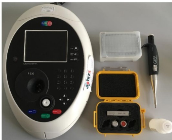
Slika 36. Uređaj NanoPhotometer P330 Spektrofotometer (IMPLEN, Njemačka) za mjerenje koncentracije DNA (Brajkovic et al. 2018).
