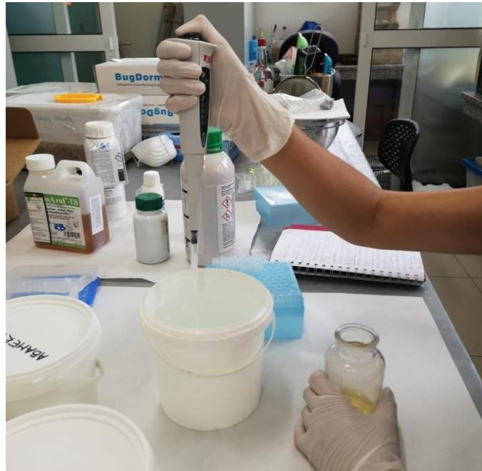
Slika 3.1. Pipetiranje insekticida u 1 L vode
