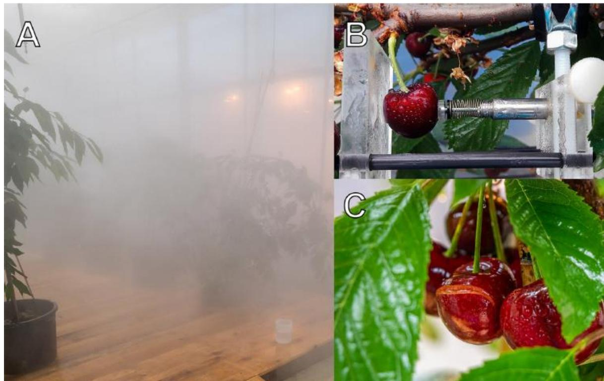
Slika 2.3. Trešnja pod simuliranim kišom u komori za maglu. A) Komora za maglu B) Plod trešnje montiran na linearni pretvarač za bilježenje promjene promjera C) Raspuknuti plodovi pod simuliranim kišom
