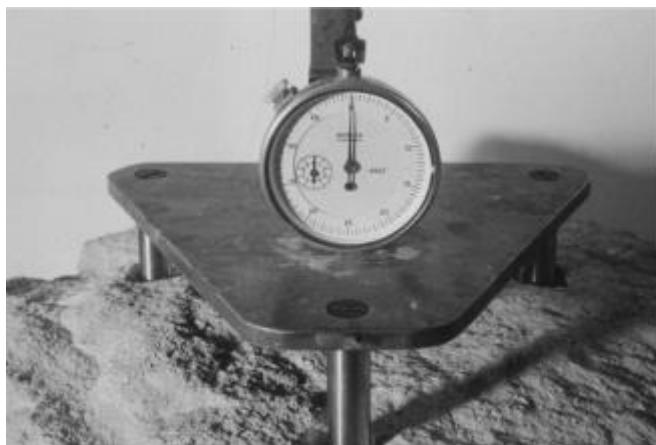
**Slika 5.** Mikro-erozijski metar
