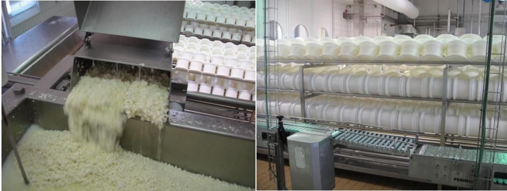
Slika 6. Prikaz izdvajanja sirutke i sirne mase, te procesa prešanja sira
