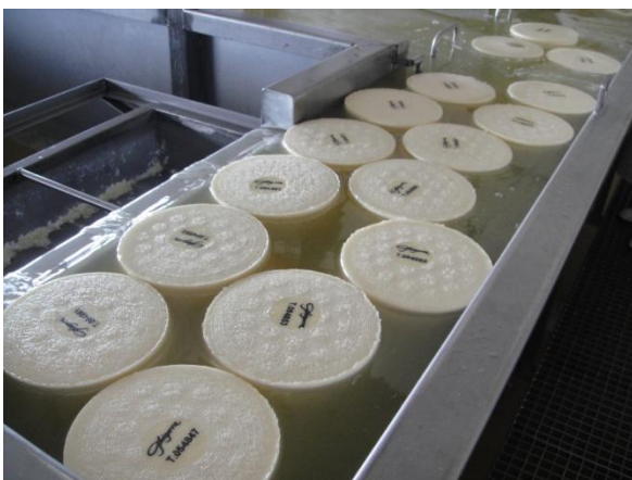
Slika 7. Prikaz soljenja sira u salamuri i procesa sušenja sira nakon vađenja iz salamure
