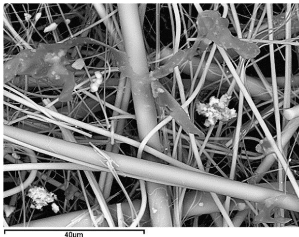
Slika 2. Elektronski mikrograf (povećanje 1 500x) heterogene smjese PM iz prostora za uzgoj zečeva prikupljene na filteru od staklenih vlakana (Cambra-López et al. 2010.)
