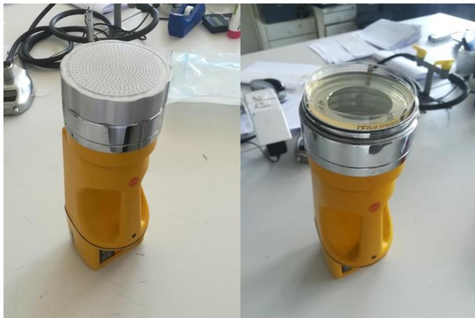
**Slika 4.** SAS Super 90 (lijevo: s aspiracijskom glavom, desno: bez aspiracijske glave)
