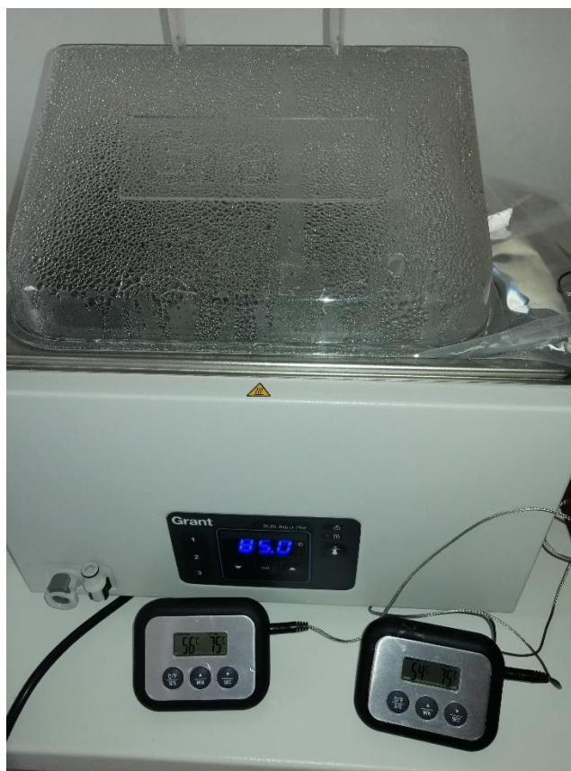
Slika 4.6. Prikaz vodene kupelji sa ubodnim termometrima
