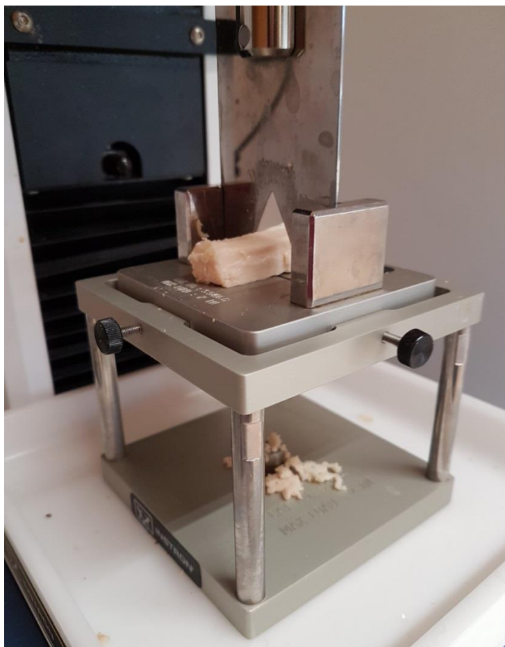
Slika 4.9. Mjerenje mekoće mesa sa Warner-Bratzler rezivim sječivom
