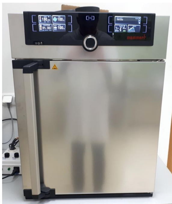
Slika 6: Memmert UN55plus laboratorijska sušnica Izvor: vlastita fotografija (Marko Gabor, 2020.)
