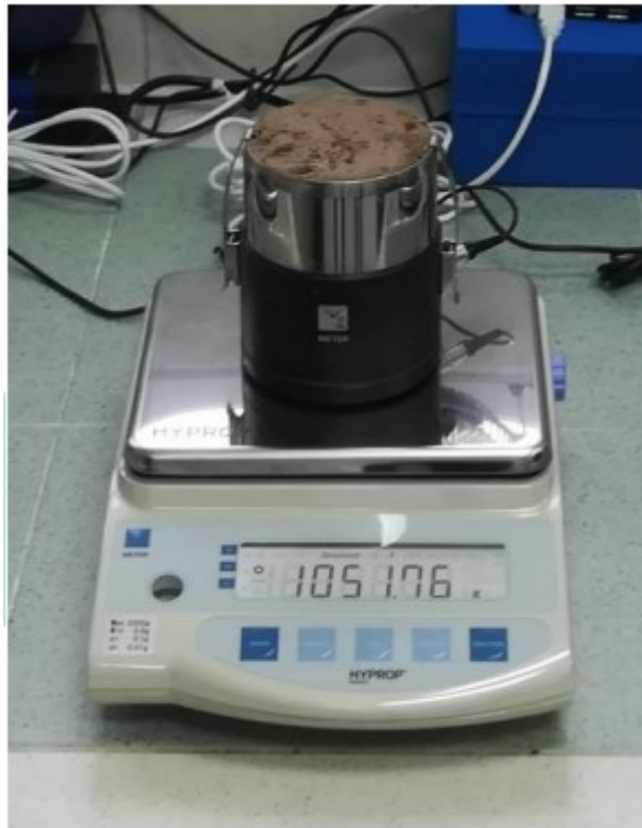
Slika 3.4.1.1. Prikaz HYPROP sustava tijekom mjerenja (Defterdarović J. i sur., 2019.)
