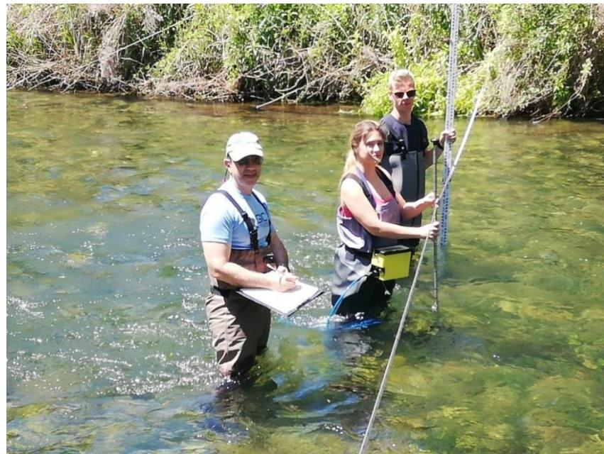
Prikaz mjerjenja brzine vode pomoću elektro-magnetskog uređaja
