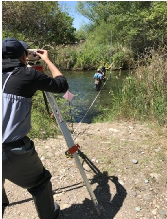
Očitavanje podataka uz pomoć optičkog mjerača na stalku
