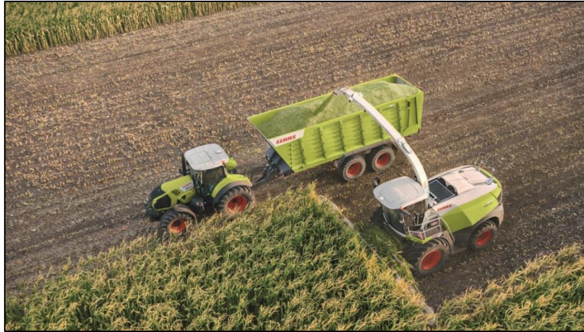
Slika 3.4. Usitnjavanje cijele stabljike kukuruza silažnim kombajnom (Izvor: https://www.weeklytimesnow.com.au/ )
