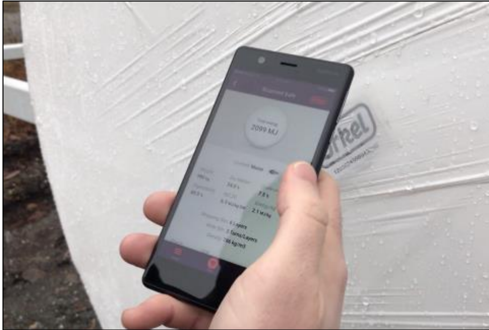
Slika 4.13. Očitavanje podataka preko RFID naljepnice
