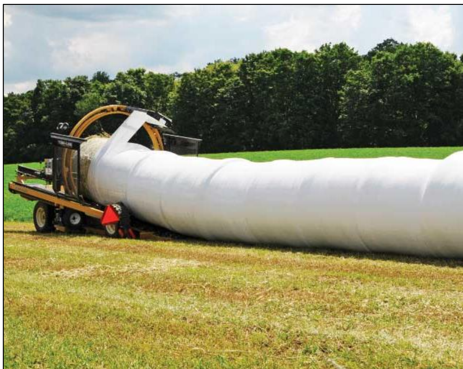
Slika 3.2. Kontinuirano omotane bale
