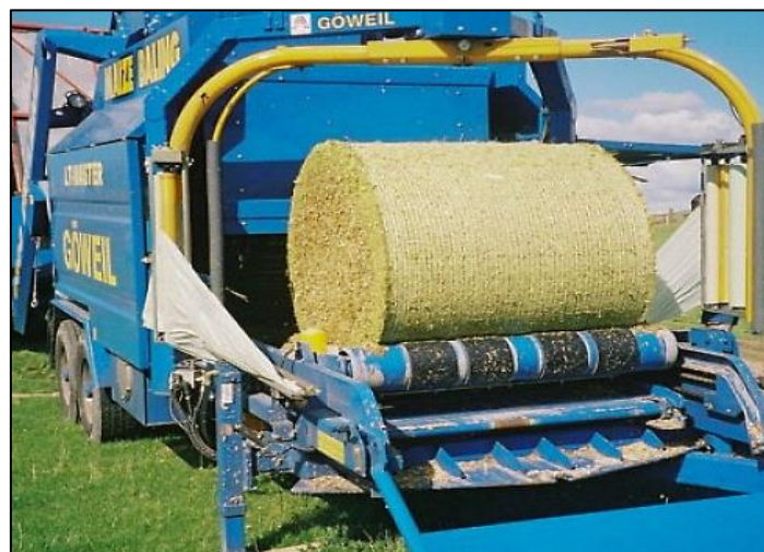
Slika 4.6. Göweil LT-Master preša i omotač za silažne bale (Izvor: https://www.webbline.co.nz/ )
