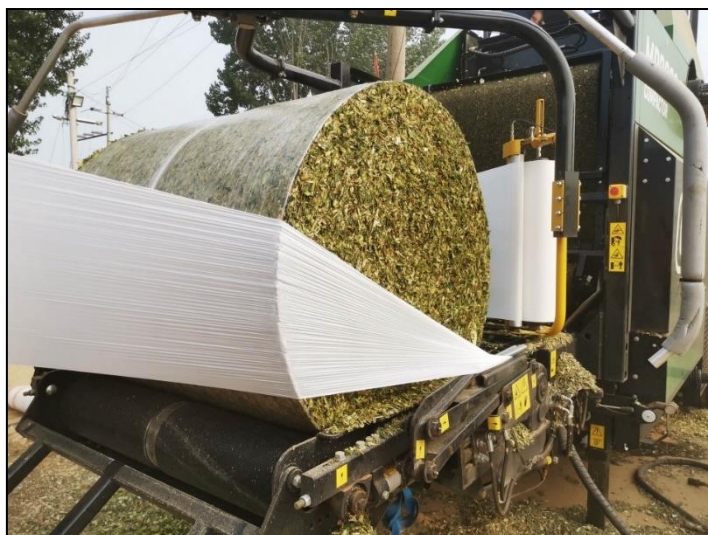
Slika 3.3. Omatanje valjkastih bala plastičnom folijom (Izvor: https://www.orkel.com/ )
