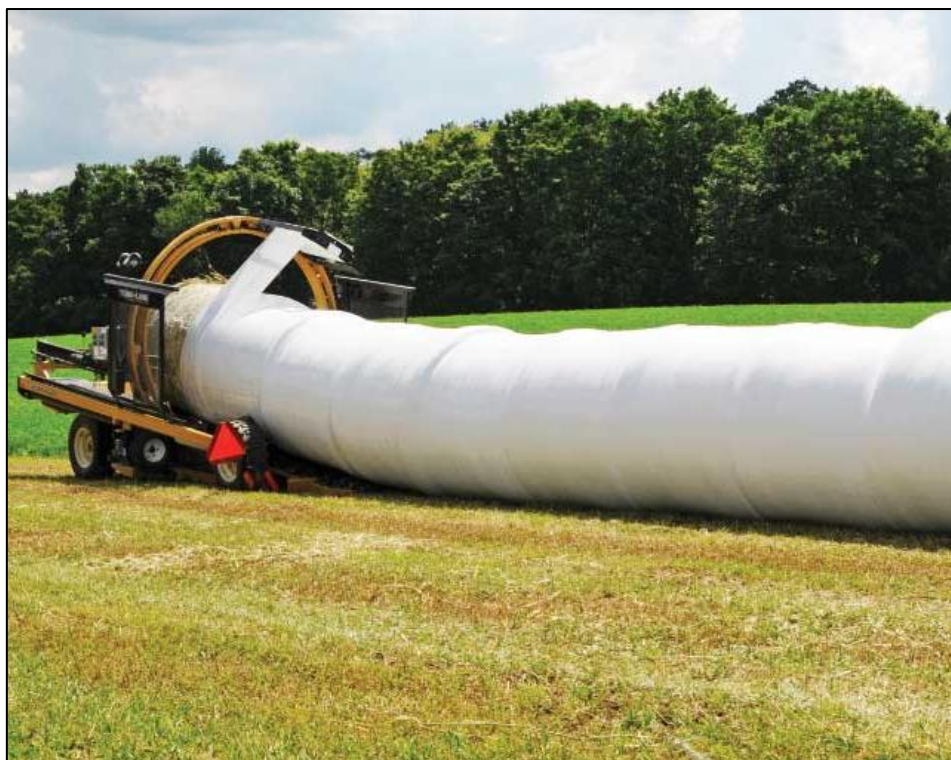
Slika 3.2. Kontinuirano omotane bale
