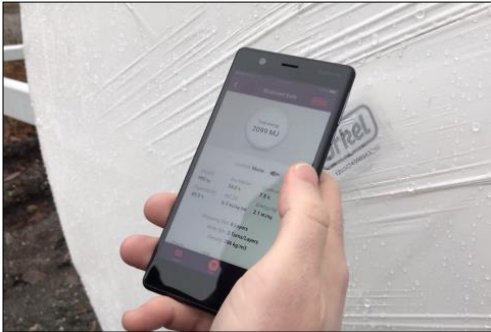
Slika 4.13. Očitavanje podataka preko RFID naljepnice
