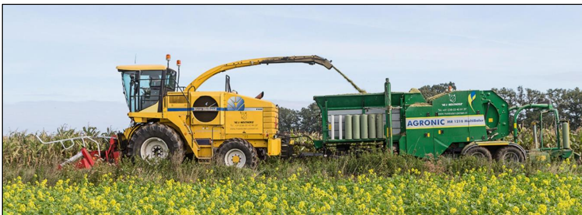
Slika 3.5. Jednofazna tehnika baliranja kukuruzne silaže (Izvor: https://www.profi.co.uk/ )
