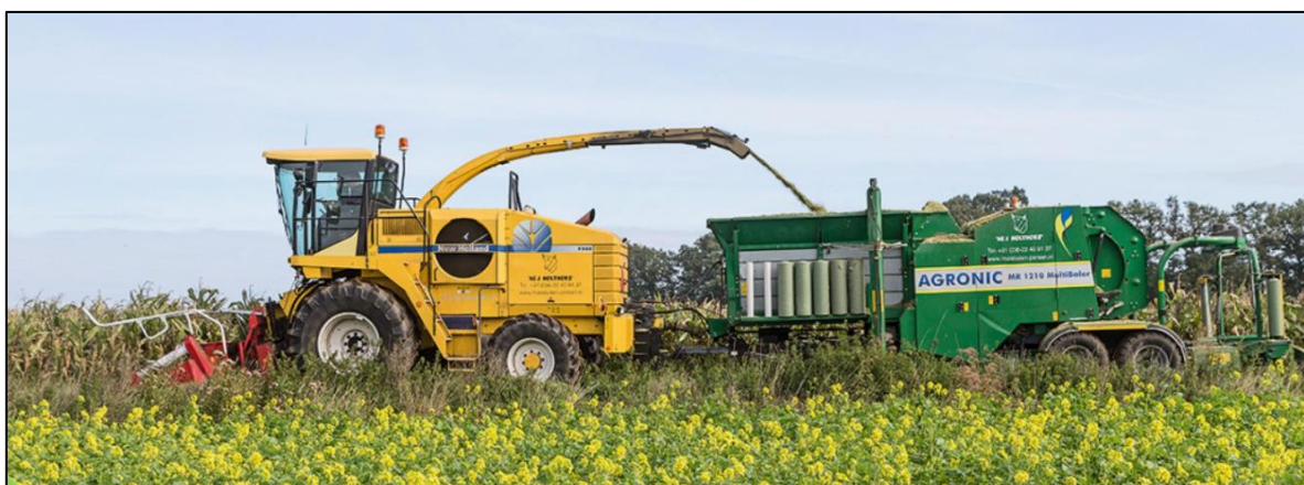
Slika 3.5. Jednofazna tehnika baliranja kukuruzne silaže (Izvor: https://www.profi.co.uk/ )
