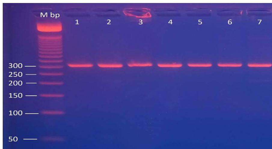
Slika 3.1. Amplifikacija sedamnaestog egzona DGAT1 gena duljine 309 baznih parova (bp) lančanom reakcijom polimeraze (PCR) u ovaca.
