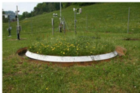
Slika 2.2.1. Kružni lizimetar
