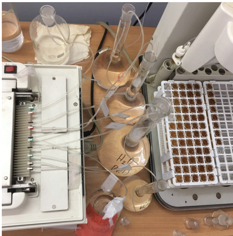
Slika 4.5.9. Protočni sustav automatskog analizatora SEAL Analytical AA3
