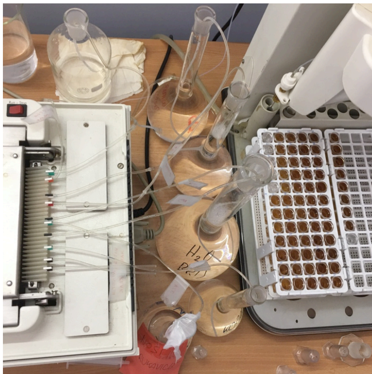
Slika 4.5.9. Protočni sustav automatskog analizatora SEAL Analytical AA3
