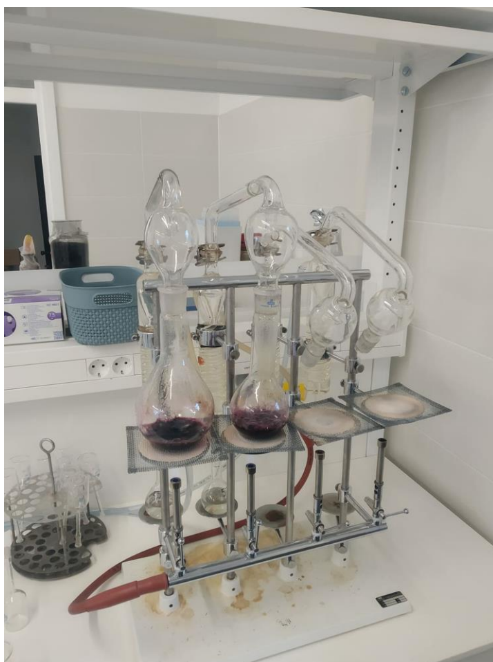
Slika 11. Destilacija vina u Kjeldahovoj tikvici (17. 12. 2019.)
