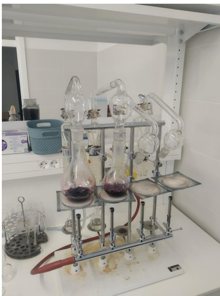
Slika 11. Destilacija vina u Kjeldahovoj tikvici (17. 12. 2019.)
