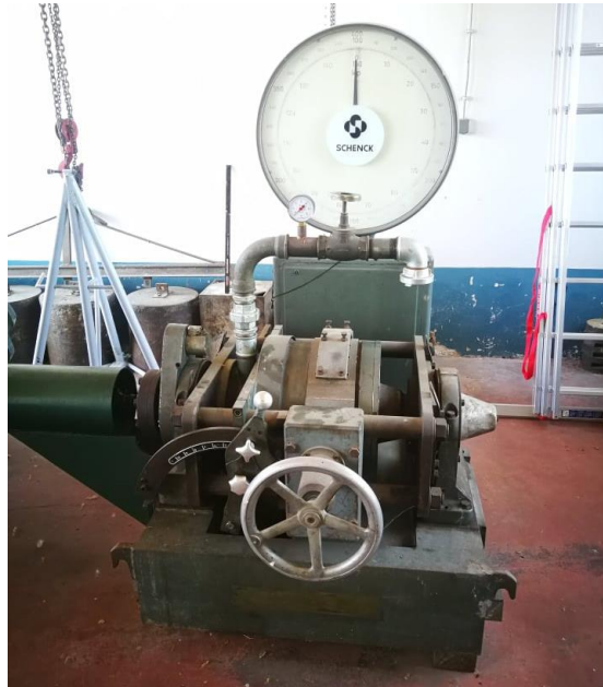
Slika 8. Hidrauličko-pojasna kočnica Schenk tip U1-40
