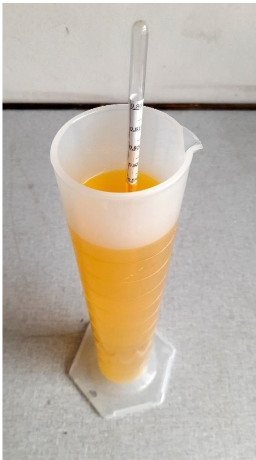
Slika 5. Dizel gorivo s 20% sojinog ulja
