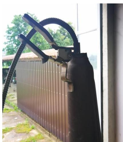
Slika 11. Sonda za ispitivanje ispušnih plinova
