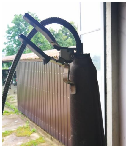
Slika 11. Sonda za ispitivanje ispušnih plinova
