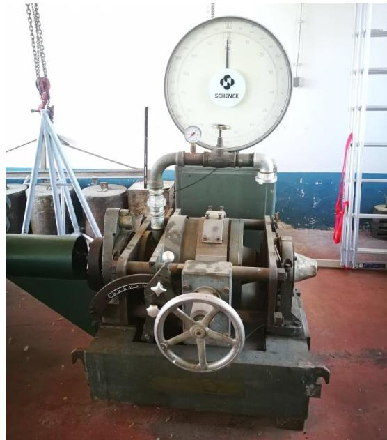
Slika 8. Hidraulička-pojasna kočnica Schenck tip U1-40
