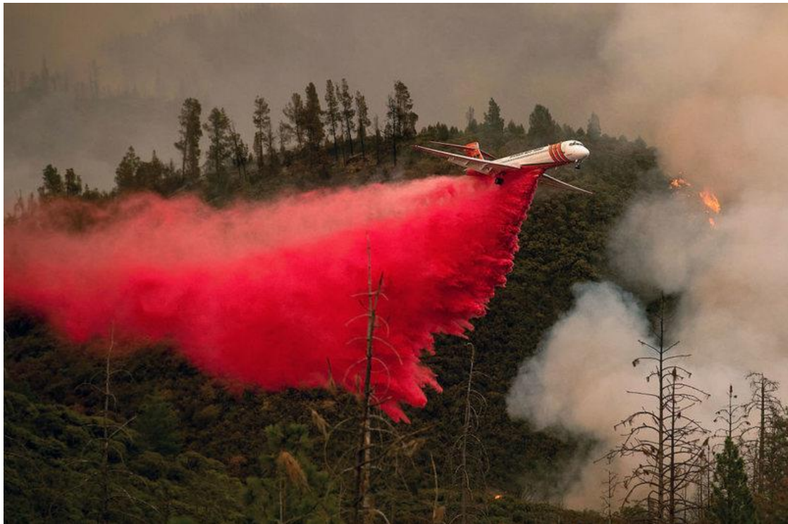
Slika 17. Vatrogasna protupožarna letjelica (primjena retardanata)
