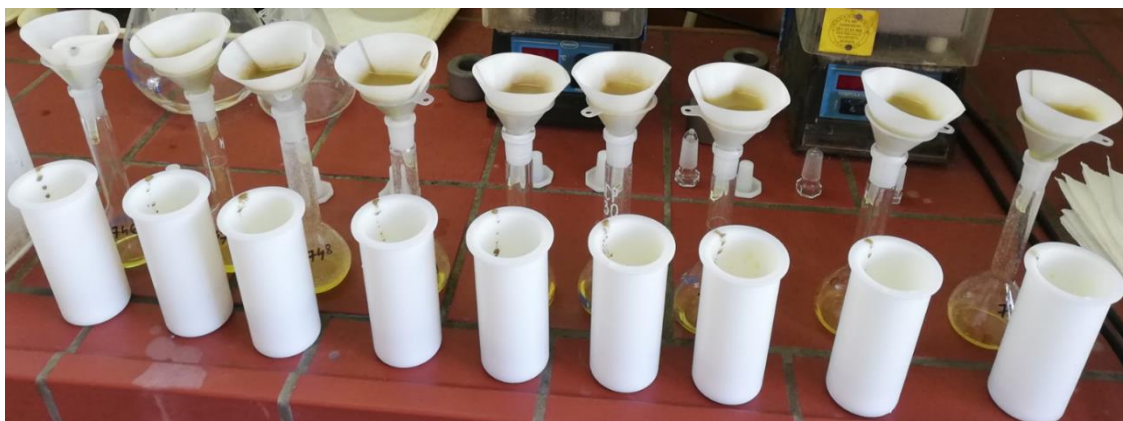
Slika 6. Filtriranje kisele otopine uzorka
